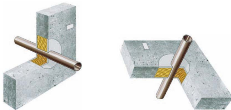
(Слика 8.4.9.1) Продор на незапаливи цевки низ секторски сид и меѓукатна конструкција
